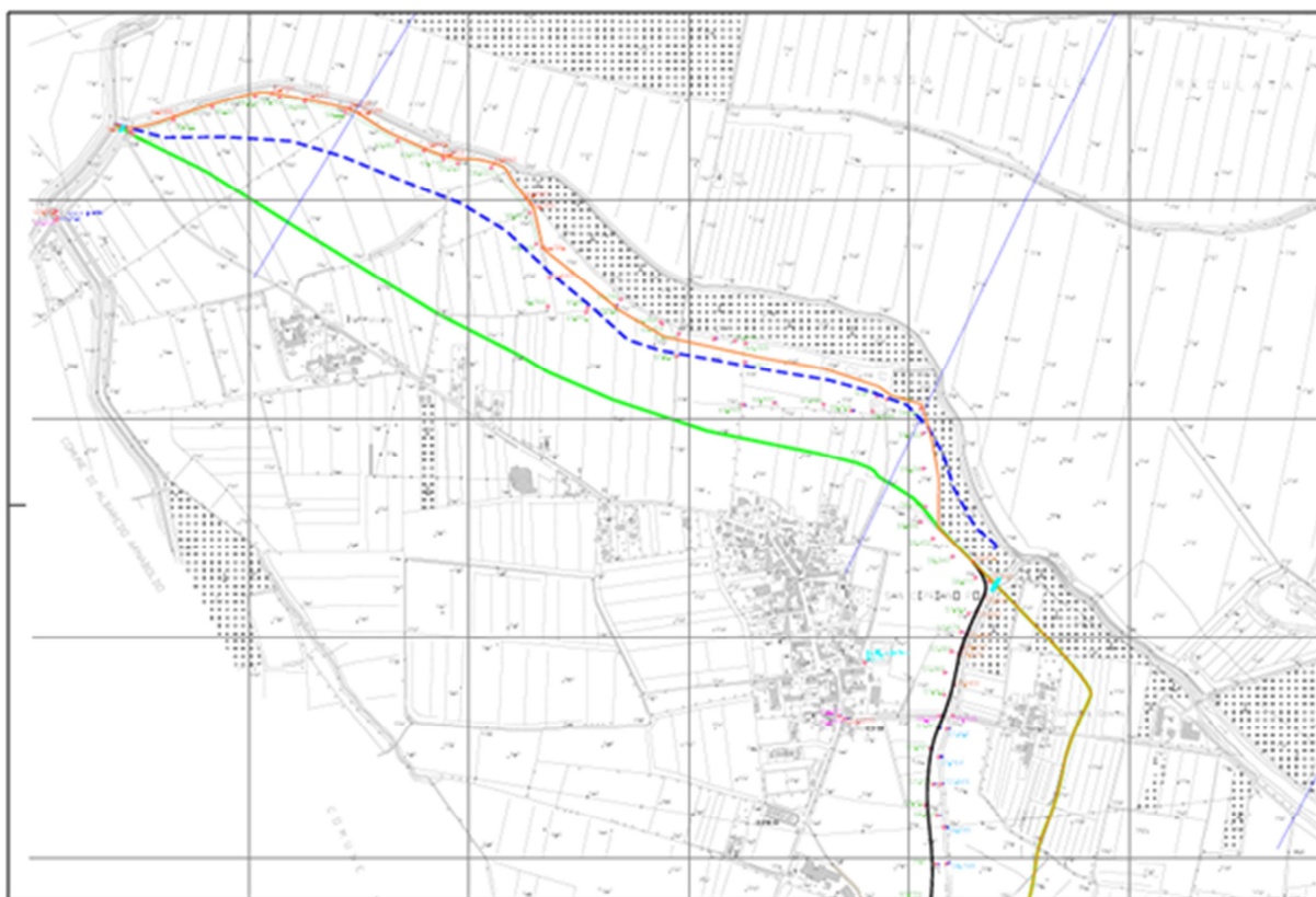
Figura 39 - Stralcio planimetrico con rappresentazione delle tre soluzioni di tracciato alternative analizzate per la realizzazione dell'argine a difesa dell'abitato di San Cipriano Po: SCENARIO 3 (in blu), SCENARIO 4 (in rosso), SCENARIO 5 (in verde).
